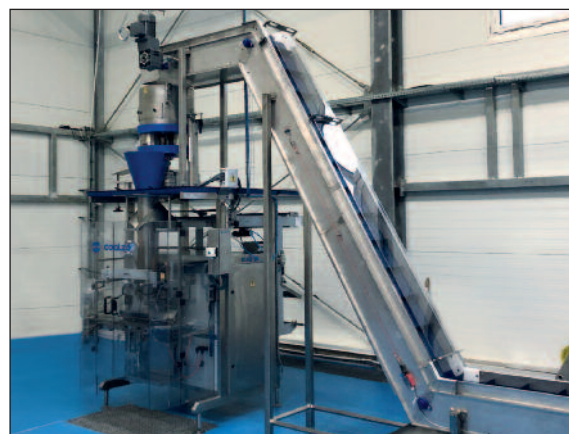
Individuell konzipierte WESSAMAT-Fördertechnik mit automatischer Abfüll- und Verpackungseinheit für Eiswürfel und Crushed-Ice
